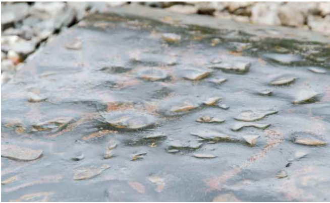
Abdrücke der Schottersteine auf den Unterschottermatten
